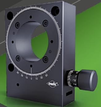
Für jede Anwendung bietet OWIS® den idealen Rotationstisch. Die Dreheinheiten DV und DT mit Schneckengetriebe garantieren eine kontinuierliche präzise Positionierung über 360°. Wenn rotationsensitive Komponenten positioniert werden sollen, sind die Winkelversteller WV mit einer Kombination von Grobstellbereich und Feinverstellung – mit Feingewinde- oder Messschrauben getrieben – die richtige Wahl.
