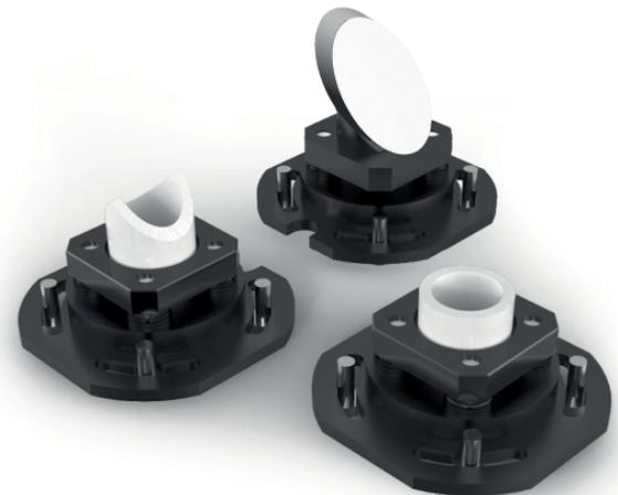
Mit den Justiereinsätzen JT 40T können diverse optische Elemente hochpräzise, erschütterungsfest und langzeitstabil justiert werden. Bewegliche Komponententräger werden dazu durch drei Schrauben mit Tellerfedern gegen eine Basisplatte verspannt.
