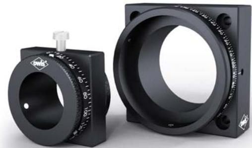
Die Drehfassungen DOH 40 und DOH 65 sind für den Einbau von Komponenten wie Polarisatoren, Verzögerungsplatten, usw. vorgesehen. Auf dem Außenring befindet sich eine Skala, mit 5° Teilungsstrichen beim DOH 40 und 2° Teilungsstrichen beim DOH 65. Die Drehfassungen DOH 40 gibt es mit Aufnahmedurchmesser 25 mm oder 25,4 mm (1"). Die DOH 65 haben einen Aufnahmedurchmesser von 56 mm. Die aufgenommenen Komponenten werden mit Gewindestiften fixiert.
