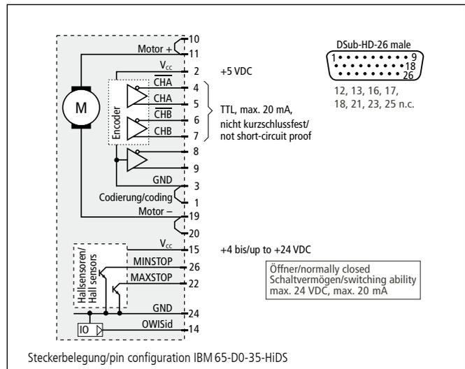
**Technische Daten/Technical Data IBM 65 (bei 20 °C/@20 °C, ohne Last/no load)**
