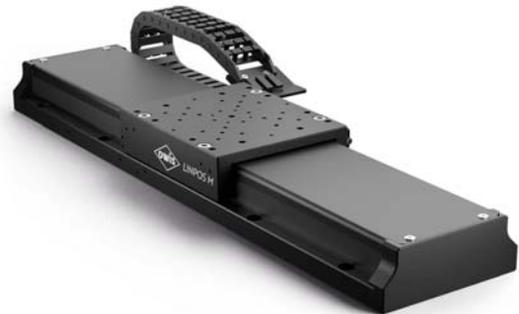
Der LINPOS M-300 kombiniert einen leistungsstarken Direktantrieb mit einem feinauflösenden inkrementellen Linearmesssystem und erlaubt somit hohe Dynamik bei höchster Präzision. Der eisenlose Linearmotor ermöglicht schnelles Verfahren mit konstanter Geschwindigkeit bis zu 950 mm/s und das ruckelfreie Rastern in kleinen äquidistanten Schritten gleichermaßen.
