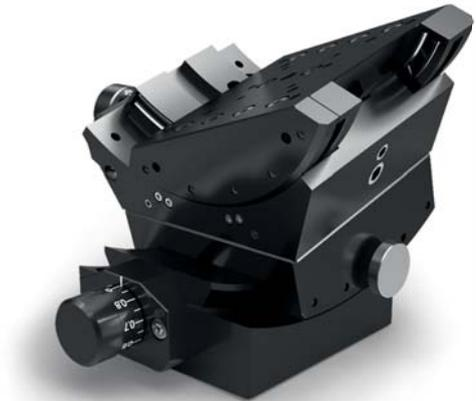
Die Theta-Phi-Goniometer TP 90-30-40-105 sind eine Kombination des Goniometers GO 90 mit Schwalbenschwanzführung (Theta) und des Hochpräzisions-Goniometers GO 65-40-65 mit speziell entwickelten Führungen (Phi). Damit ist eine präzise Positionierung um einen definierten optischen Punkt von  $\pm 20^\circ$  (Phi) bzw.  $\pm 15^\circ$  (Theta) möglich.
